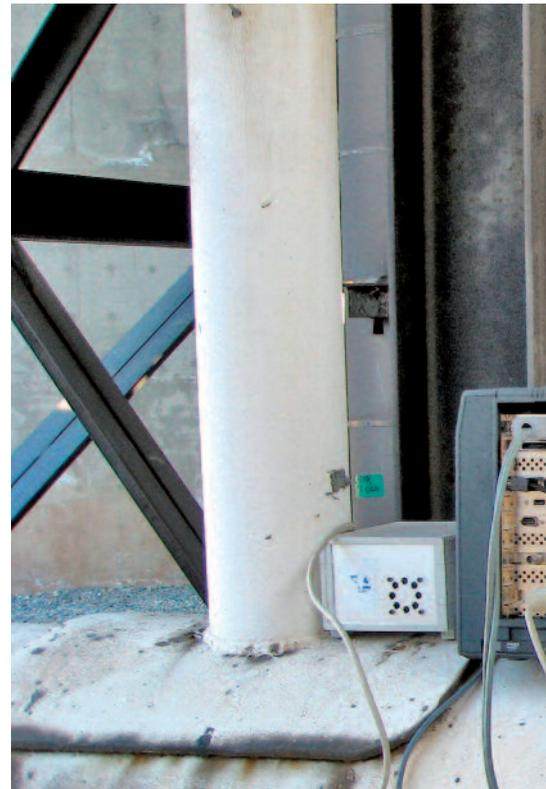
Un expert de SGS analyse la structure d'un tuyau d'acier (ici dans un bâtiment en Corée du Sud) pour détecter la présence éventuelle d'hydrogène, source de défaut. Les données sonores sont converties en images numériques permettant de localiser les possibles défauts.
