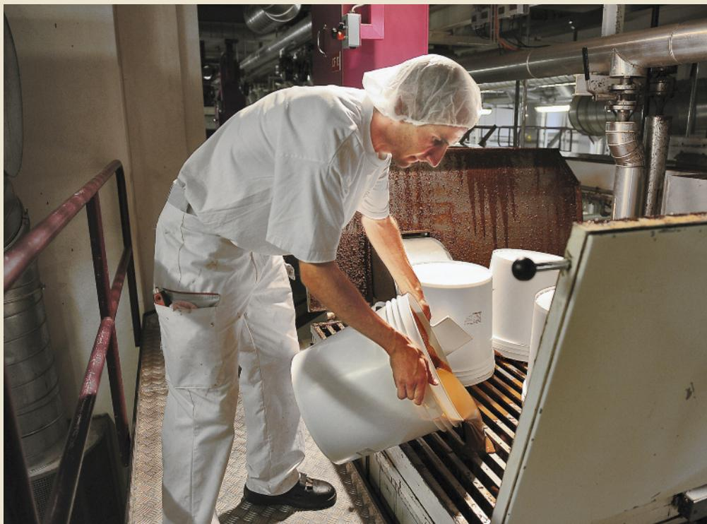
Les fèves de cacao sont broyées jusqu'à l'obtention d'un liquide brun foncé très lisse, appelé liqueur ou pâte de cacao. La torréfaction préalable des fèves permet de développer l'arôme du chocolat.
