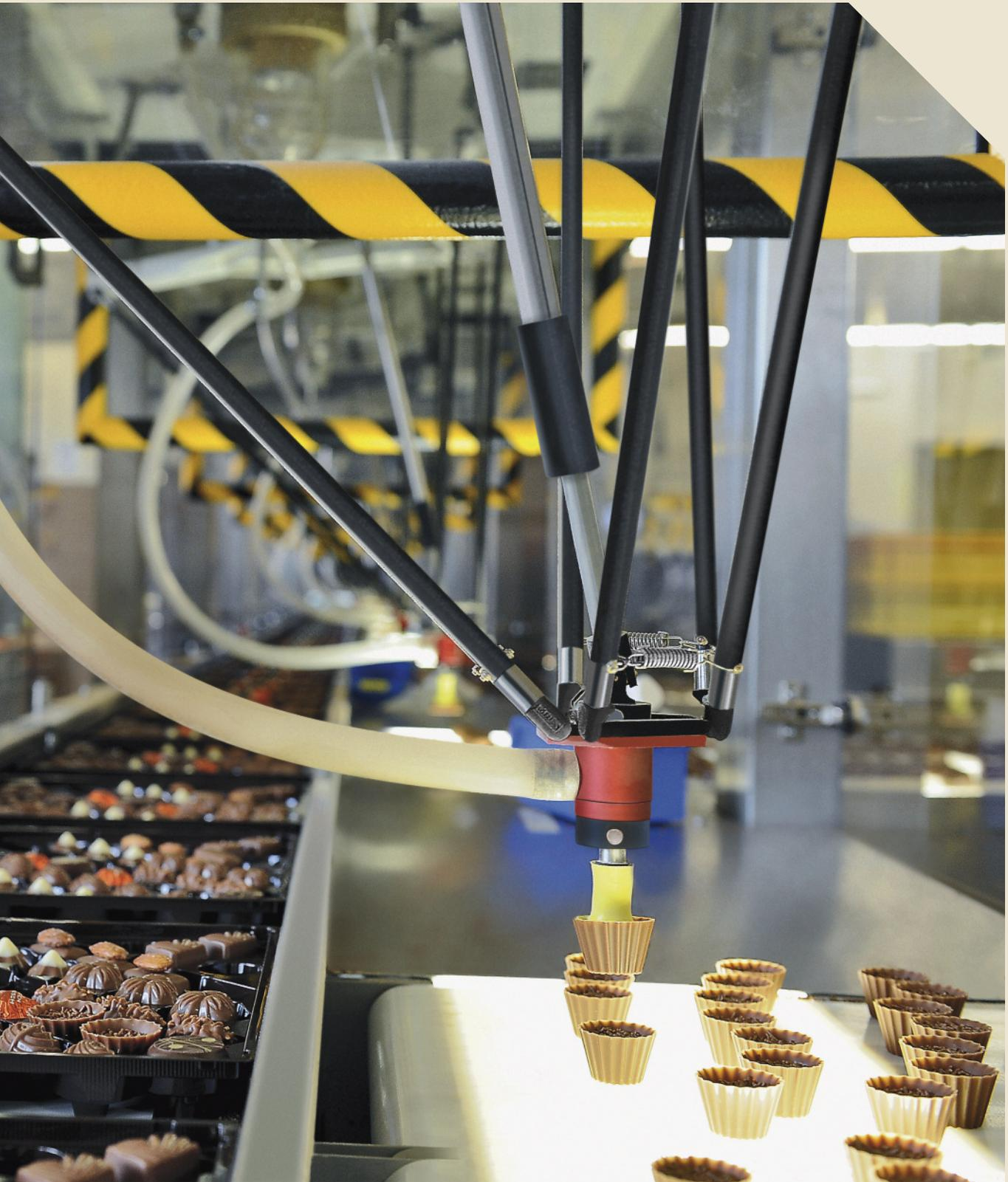
La disposition des pralinés dans les boîtes est automatisée, avant d'être vérifiée à la main. Chaque robot dépose 120 chocolats par minute dans les alvéoles.
