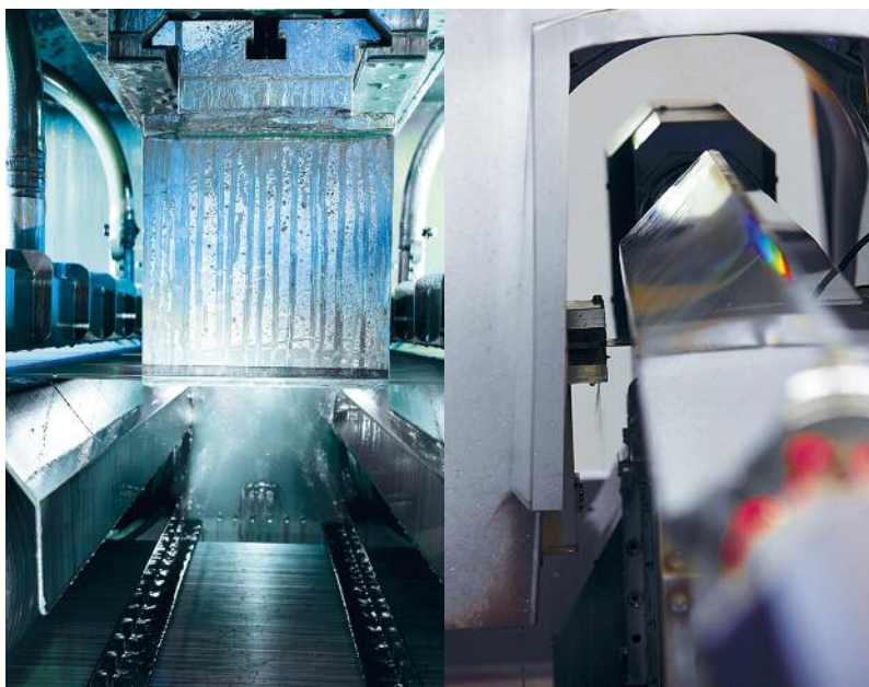
Ces machines de Meyer Burger calibrent les lingots de silicium, pour les couper ensuite en fines lamelles qui serviront aux cellules solaires.
