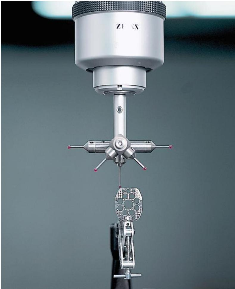
Cet outil est utilisé dans les usines de fabrication de Synthes pour vérifier si les produits fabriqués sont conformes aux spécifications.
