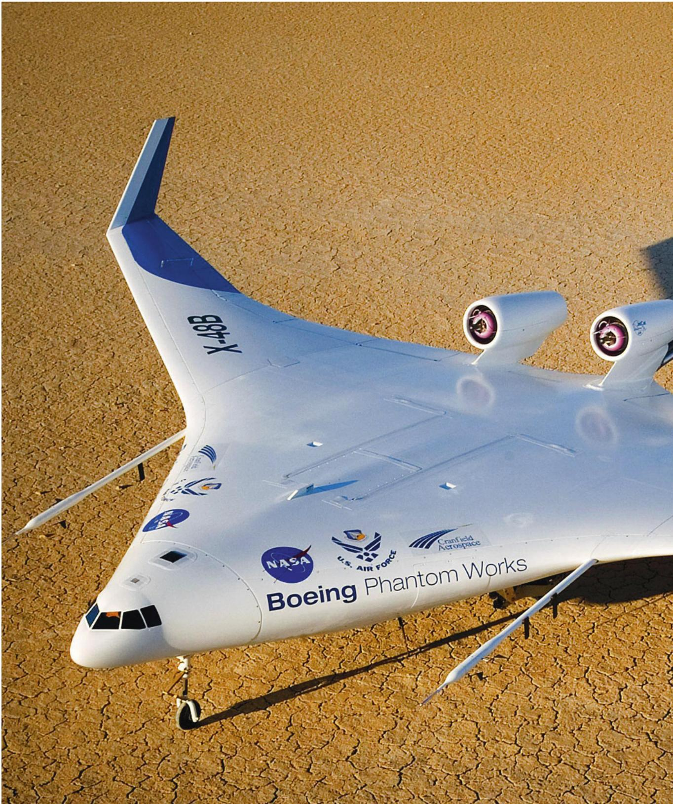
Airbus et Boeing travaillent sur des ailes volantes, un concept qui permet de réduire drastiquement la consommation.
