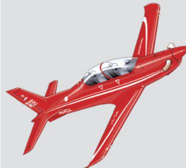
Le nec plus ultra en matière d'entraînement militaire. Doté d'un moteur encore plus puissant et d'une surface ailée réduite, le descendant du PC-9 se rapproche encore un peu plus du comportement d'un jet. L'agencement high-tech du cockpit reproduit celui du FA/18.
